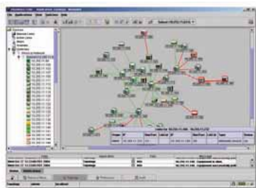
Funkcje wykrywania i obsługi topologii umożliwiają odwzorowanie urządzeń oraz łączy międzysieciowych
